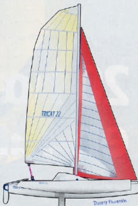
Voilure très élancée, coques volumineuses, dérives sabre en carbone, mât tournant, le Tricat 22 joue la carte de la performance.
