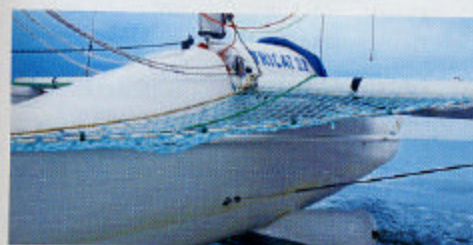
Des détails très étudiés : le filet pour assurer l'équipier à l'avant, les dérives sabre faciles d'utilisation et le mât pivotant pour mieux faire travailler la grand-voile.
