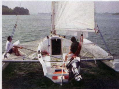
permettent d'envisager le camping côtier en famille, tout en se faisant plaisir en navigation. Baïlle à mouillage, petite jupe sur laquelle est monté un moteur hors-bord, bras repliables, dérive relevable, le Tricat 25 prône la simplicité.
